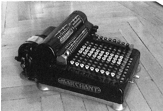
Marchant KC, máquina Sistema Odhner que tiene la particularidad de disponer de teclado completo y motor eléctrico
