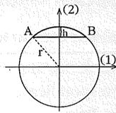
Se utiliza un encofrado de madera para fundir el hormigón. En la figura 1 se ve un dibujo, en corte vertical, del encofrado de un tejado de forma circular. En la figura 2, la circunferencia está trazada en un sistema de coordenadas. El arco AB corresponde al encofrado, y  $h$  es la altura mayor del encofrado, por encima de la cuerda AB, con  $AB = 9$  m, y  $h = 1,5$  m.
