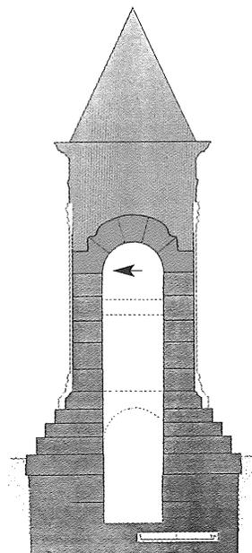
Figura 2. Hipotética reconstrucción del monumento con el último cuerpo en pináculo realizada por Abad y Bendala. Se observa como las cinco dovelas que conforman la bóveda están perfectamente integradas en el muro (la flecha indica el lugar de medición)
