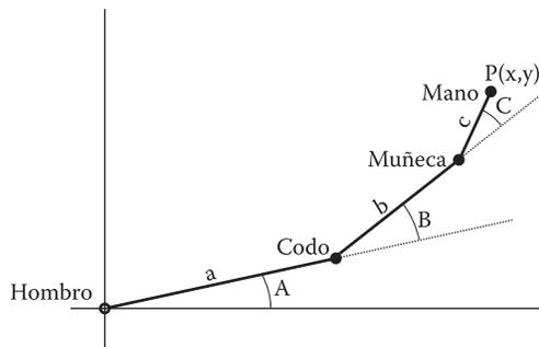
Esta posición representada aquí correspondería al brazo derecho. Las amplitudes  $B$  y  $C$  se han tomado con relación a las direcciones de los segmentos precedentes (brazo y antebrazo). El estropajo se halla en el punto  $P(x,y)$ :
