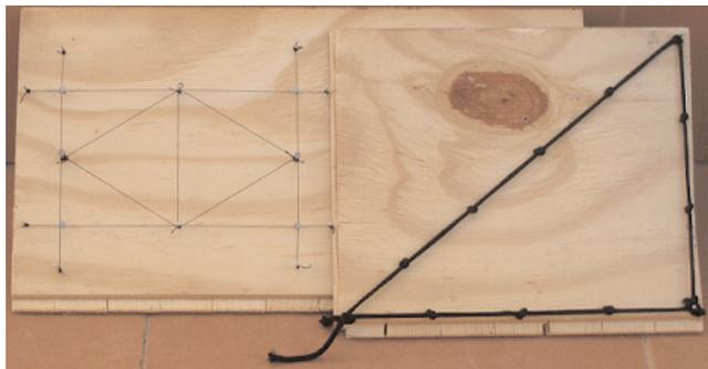
Figura 16. Construcción del rectángulo en proporción  $\sqrt{3}$ , ayudado de la cuerda de 12 nudos
