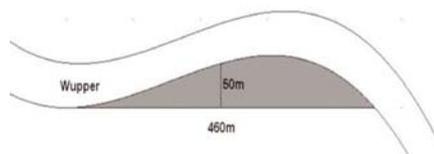
Se facilita a los estudiantes un plano donde se muestra el perfil del río Wupper, sin ningún sistema de coordenadas dibujado y se sabe que el precio del terreno señalado en gris sobre el plano es de 12 € el metro cuadrado. Se pide:
