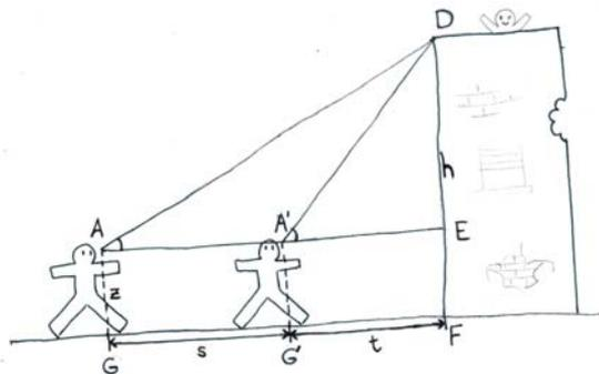
Hay que medir directamente con el metro las longitudes (mira el esquema)  $z = AG$  y  $s = GG'$  y con el transportador los ángulos  $A$  y  $A'$ . Apunta las medidas aquí:
