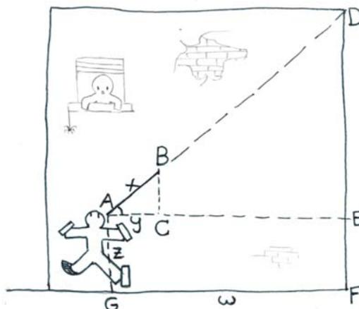
Hay que medir directamente con el metro las longitudes  $z=AG$  y  $w=GF$ , y con el transportador el ángulo  $A$  (date cuenta de que ahora las medidas pueden ser distintas que en el método I).
