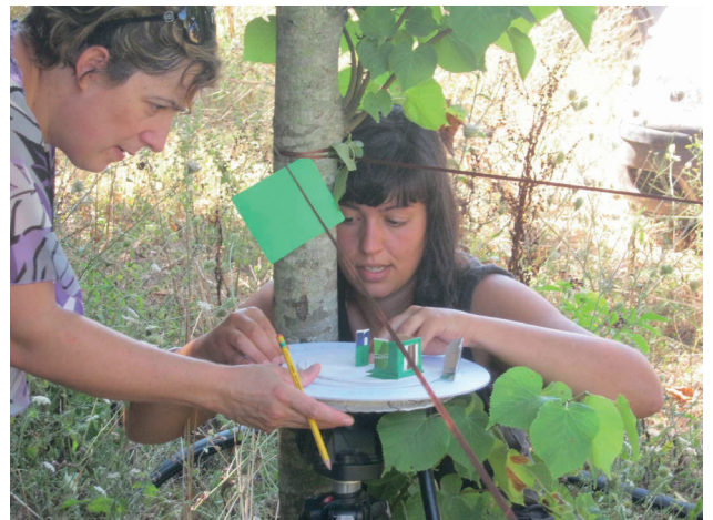
Figura 6. Resolviendo dificultades en la toma de datos con la dioptra
