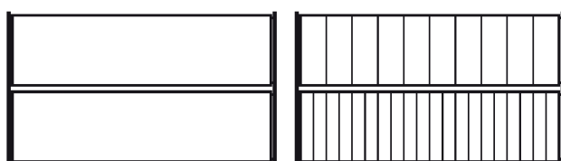
Figura 5. Estructuras metálicas antes de colocar las traviesas verticales y con las traviesas colocadas
