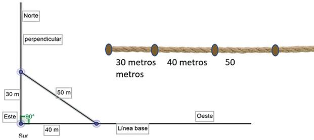
Figura 3. Aplicación del Teorema de Pitágoras para dibujar ángulos rectos
