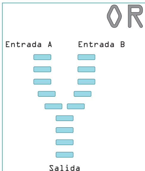
Figura 8. Trazado de dominó para la puerta lógica OR
