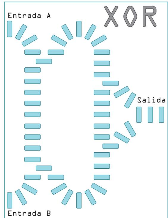
Figura 1. Trazado de dominó para la puerta lógica XOR
