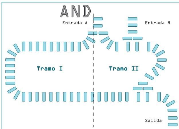
Figura 4. Trazado de dominó para la puerta lógica AND (El trazado ocupa un DIN A3. La línea discontinua divide el trazado en dos tramos de tamaño DIN A4)
