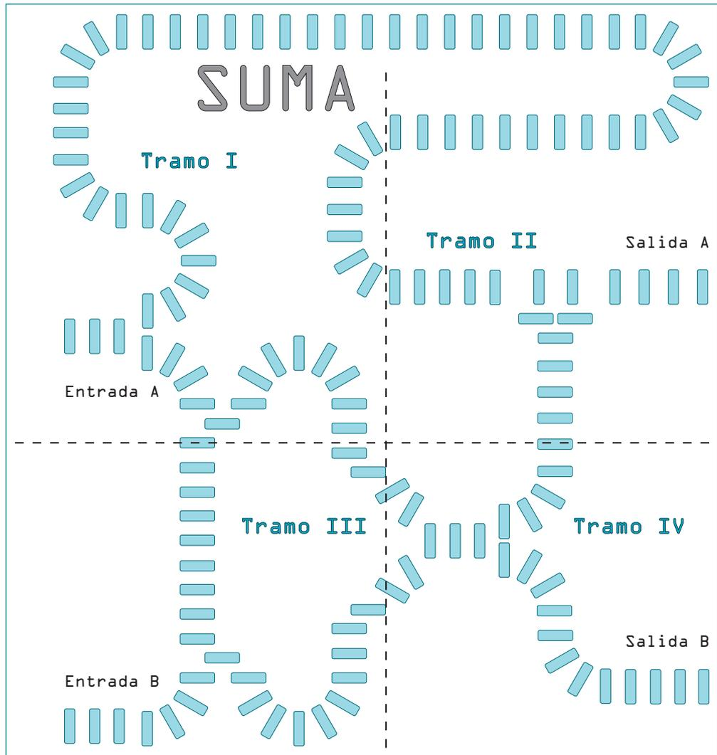
Figura 7. Trazado de dominó para la suma binaria (El trazado ocupa un DIN A2. La línea discontinua divide el trazado en cuatro tramos de tamaño DIN A4)
